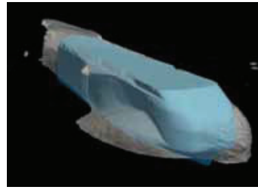
図15 ウインドアシスト船型の圧力分布図(30度斜め向かい風)
