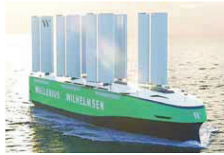
図7 ワレニウスが開発するGHG 90%削減船
